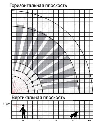
10м линза с объемной зоной обнаружения для извещателя невосприимчивого к движению ЖИВОТНЫХ (Colt Quad PI)
