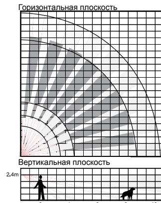
10 м линза с объемной зоной обнаружения для извещателя невосприимчивого к движению ЖИВОТНЫХ (Magnum PI)
